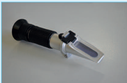
Le réfractomètre, un petit appareil facile à utiliser en élevage
