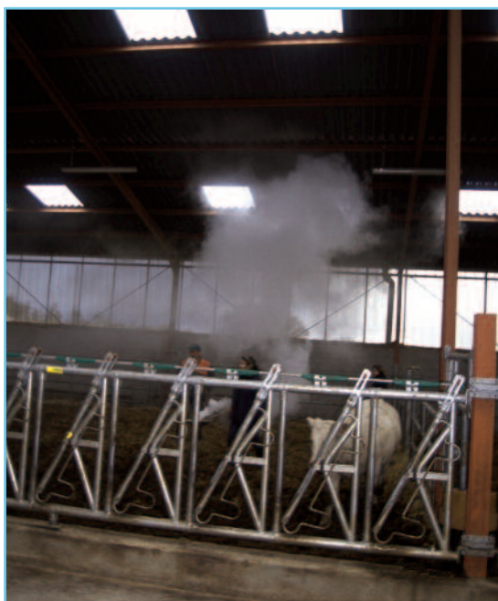
La circulation de l'air dans un bâtiment peut être mise en évidence au moyen de fumigènes, à l'occasion d'un diagnostic d'ambiance réalisé en présence de l'éleveur par un conseiller habilité (Source : GDS, Chambres d'agriculture)
